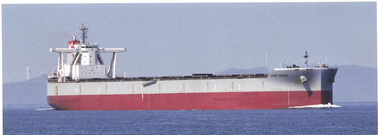
ばら積み貨物船 ケープ・グリーン 総トン数 93000トン、載貨重量 183000トン、排水量 210000トン
